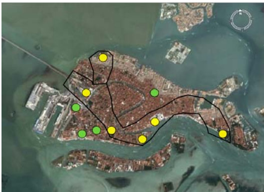
Fig. 3b In giallo i punti di misura di prospezione sismica passiva che hanno riscontrato la presenza della struttura sedimentaria ( multistorey sandbody ), in verde i punti dove tale rifratore non è presente ( cyclothemetic organization ).
