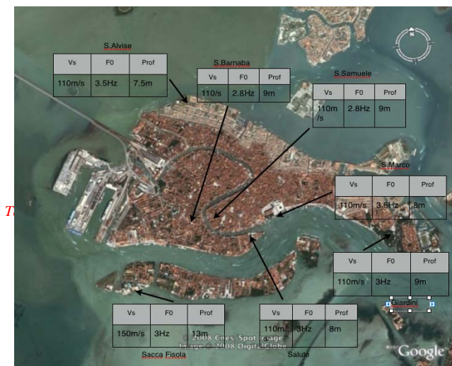
Fig. 2 – Vs, frequenza propria e profondità stimata del rifrattore per i punti di indagine
