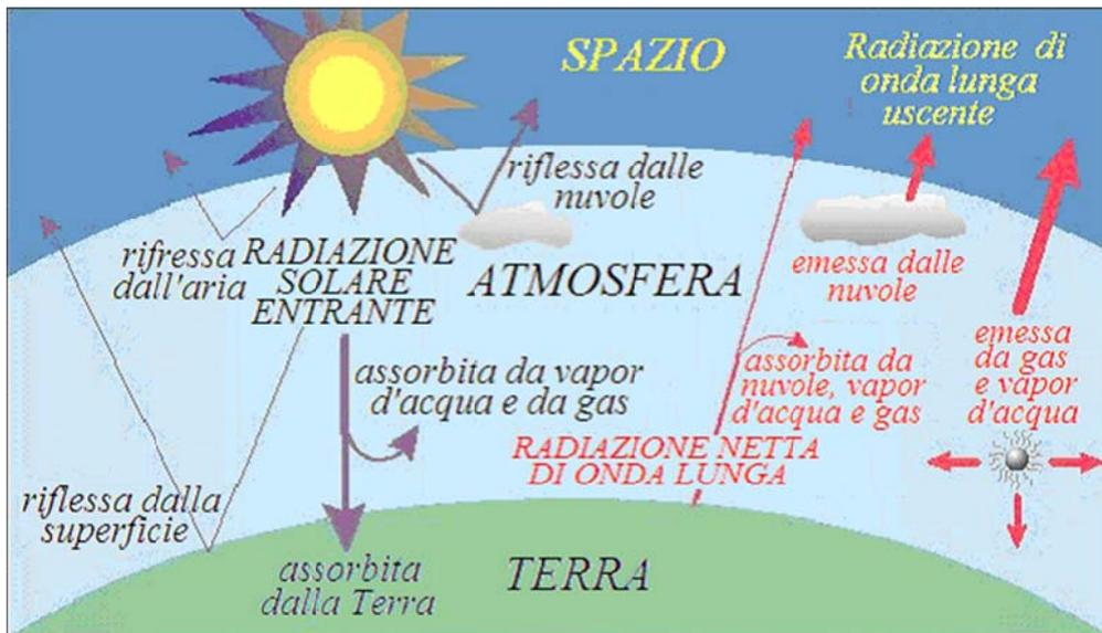
Fig. 1. – Meccanismi di trasmissione e cattura dell'energia solare.
